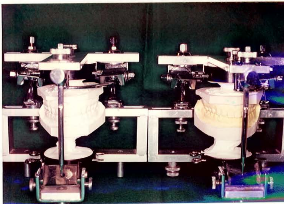
Fig. 4 - Modelos de "gesso comum + abrasivo" e "modelos controle" montados em idênticas condições
