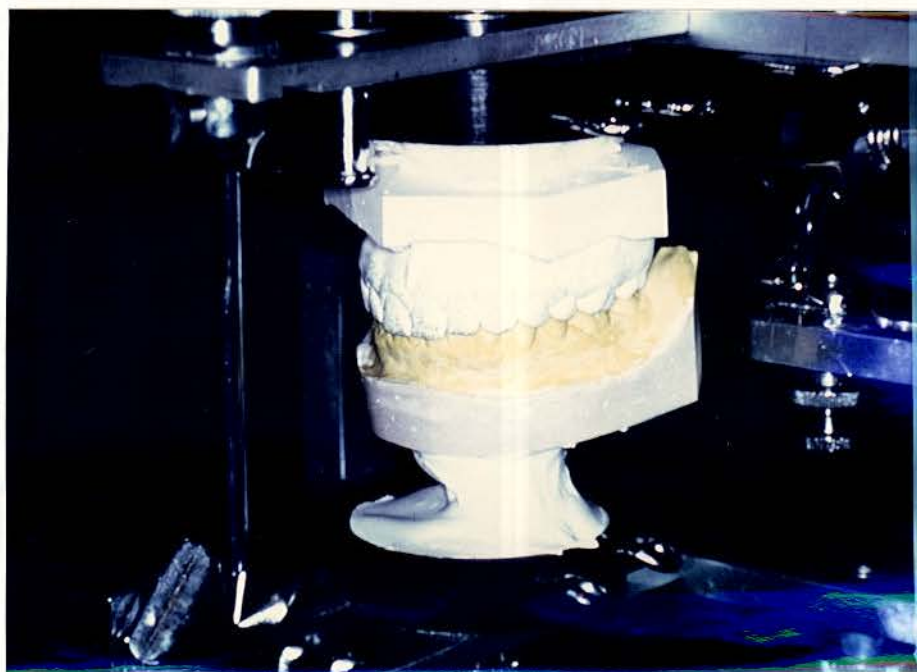
Fig. 3 - Modelo superior de "gesso comum + abrasivo" montado sobre o "modelo controle" inferior.
